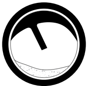
Şekil D / Buhar Kaçağı
